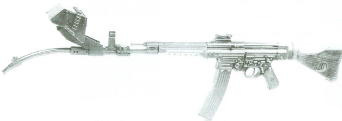
Bovenste foto: Eén van de weinige bewaard gebleven versies van de Vorsatz J , hier nog voorzien van een vizier met spiegels (MoD Pattern Room).
