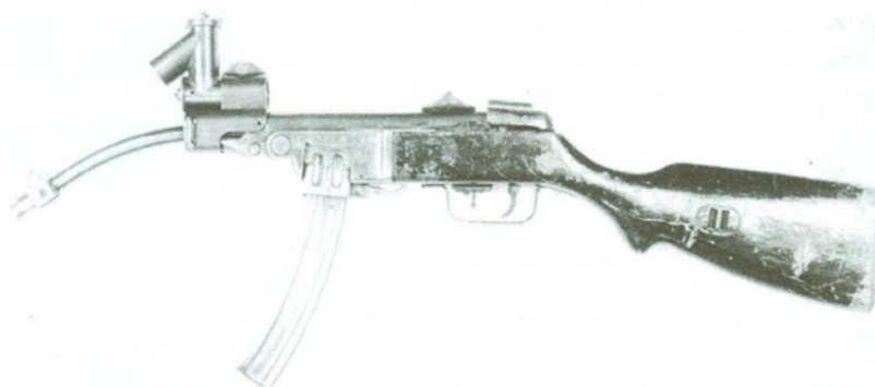
Middelste foto: Een Russische PPsH 41 pistoolmitrailleur met gekromde loop en prismavizier. De loop kan bij dit wapen naar links, rechts en naar beneden worden gedraaid (Artilleriemuseum St. Petersburg).
